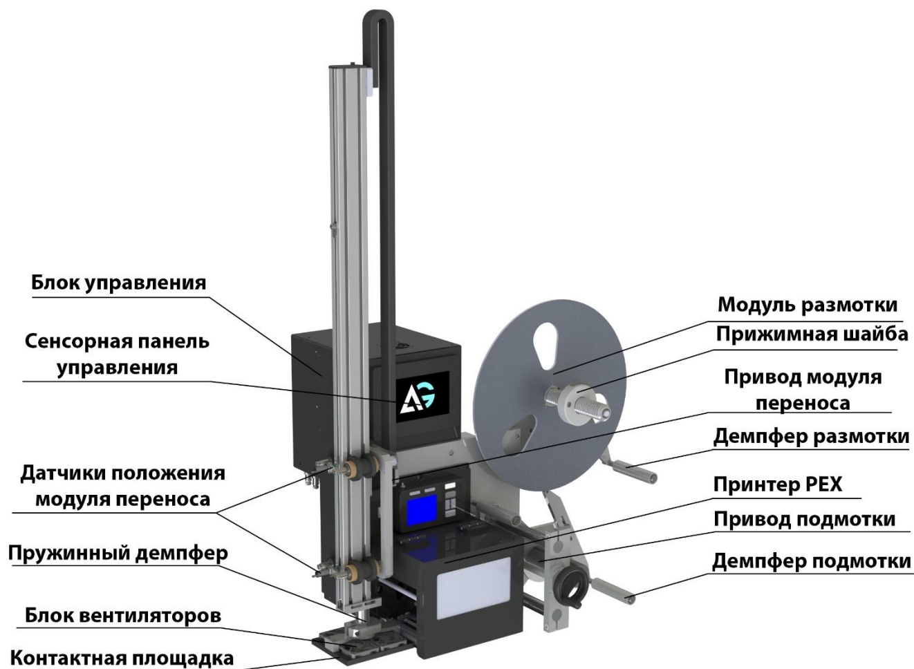
Рисунок 2.1. Внешний вид и обозначение основных узлов принтера-аппликатора этикеток Н-ПР-01.600-ЭЛ.
