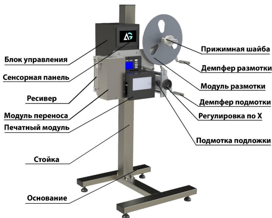
Рисунок 1.5. Внешний вид и обозначение основных узлов принтера-аппликатора этикеток Н-ПР-06.
